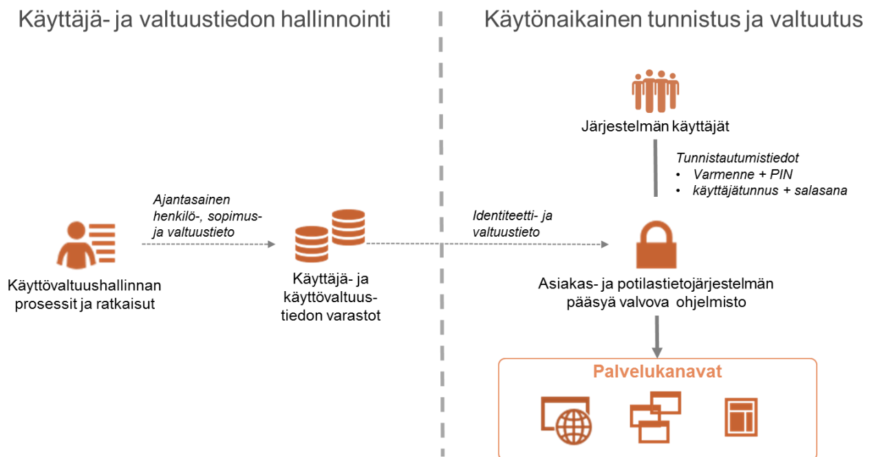
Kuva 3 Käyttövaltuushallinta ja pääsynhallinta
